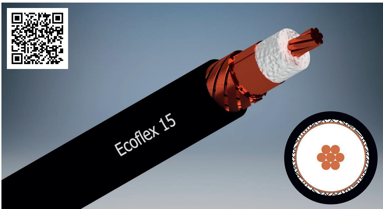
Ecoflex 15 ist ein flexibles und dabei sehr dämpfungsarmes 50 Ohm Koaxialkabel für den Frequenzbereich bis 6 GHz. Modernste Produktionsverfahren und die Verwendung eines verlustarmen PE-LLC-Dielelektrikums mit einem Gasanteil von über 70 % ermöglichen geringe Dämpfungswerte.
