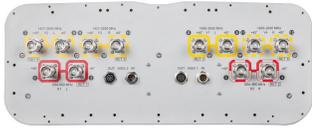
Sektorantenne mit 12 Ports, 4x 694– 960, 4x 1427– 2690 und 4x 1695-2690 MHz, 65° HPBW, 6x RET
