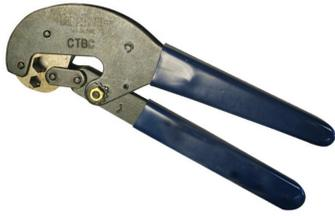
Crimpzange für CNT-300 und CNT-400 Steckverbinder
