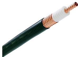
AVA6RK-50, HELIAX® Andrew Virtual Air™ Koaxialkabel, gewelltes Kupfer, 1-1/4 Zoll, schwarz, feuerhemmender Polyolefinmantel B2ca-s1b, d2,a1 (CPR-Tests werden jährlich durchgeführt, bitte beziehen Sie sich auf die Website für die neueste Klassifizierung)
