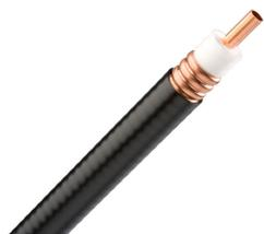
AVA5RK-50, HELIAX® Andrew Virtual Air™ Koaxialkabel, gewelltes Kupfer, 7/8 Zoll, schwarz halogenfrei, feuerhemmender Polyolefinmantel B2ca-s1a, d2,a1 (CPR-Tests werden jährlich durchgeführt, bitte beziehen Sie sich auf die Website für die neueste Klassifizierung)
