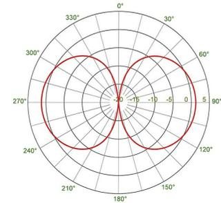
TYPISCHES STRAHLUNGSDIAGRAMM FÜR 2 M BAND (HORIZONTAL) :
