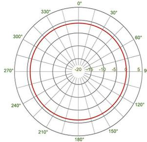
TYPISCHES STRAHLUNGSDIAGRAMM FÜR 2 M BAND (VERTIKAL) :
