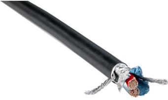
Câble d'alimentation HELIAX®, blanc et rouge avec blindage en cuivre avec une quantité de 2x10 mm<sup>2</sup> conducteurs et 2x5mm<sup>2</sup> fils de drainage, résistant aux flammes CPR Classe B2ca s1, d2, a1, 500 mètres
