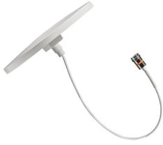
Antenne omnidirectionnelle Cell-Max™ Low PIM pour bâtiment, 617-960, 1400-1600, 1695-2700 MHz, 3300-4200 MHz et 4900-6000MHz 4.3-10, Non recommandée pour les plafonds métalliques
