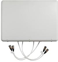
4X4 MIMO-Außenantenne mit niedrigem PIM-Richtwert, 698– 960 MHz, 1695– 2700 MHz und 3300– 4200 MHz
