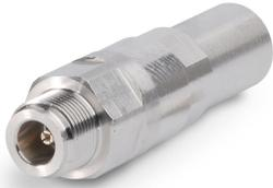
Typ N Buchse mit positivem Anschlag™ für 1/2 Zoll AL4RPV-50, LDF4-50A, HL4RPV-50 Kabel
